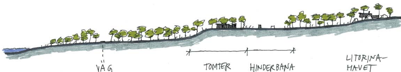
Sektionsskiss. Byggnaden ligger ovan klintkanten mot havet. Utsikten blir friare samtidigt som byggnaden är mer dold från vägen.
