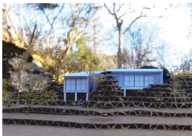
Modelfoto, Skälsö Arkitekter. Littorinahavet Trähus upplyft på plintar och inpassat mellan befintliga raukar. Minimala ingrepp på befintlig mark.
